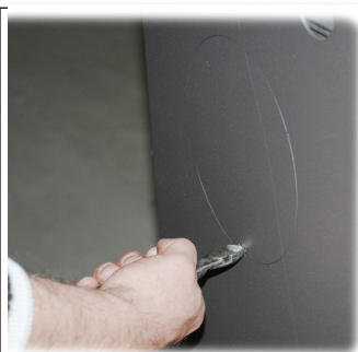
Fig. 1 Klip det lille stykke metal over, der forbinder dækslet med bagpladen med en skævbider. Vrid derefter dækslet af.
