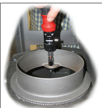
Fig. 4 Løsn boltene i røgtuden ovenud.
